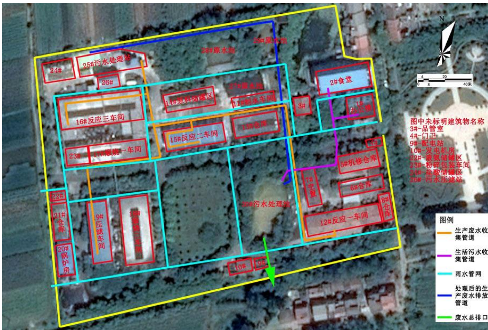
附图 4-1、一园区雨污水管网图
